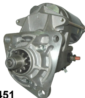
SN-1526 2.5kw, CW, 13T OEM:228000-467
